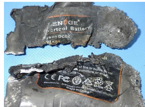
写真 2-3 焼損したバッテリーパック②（赤丸）非純正品
